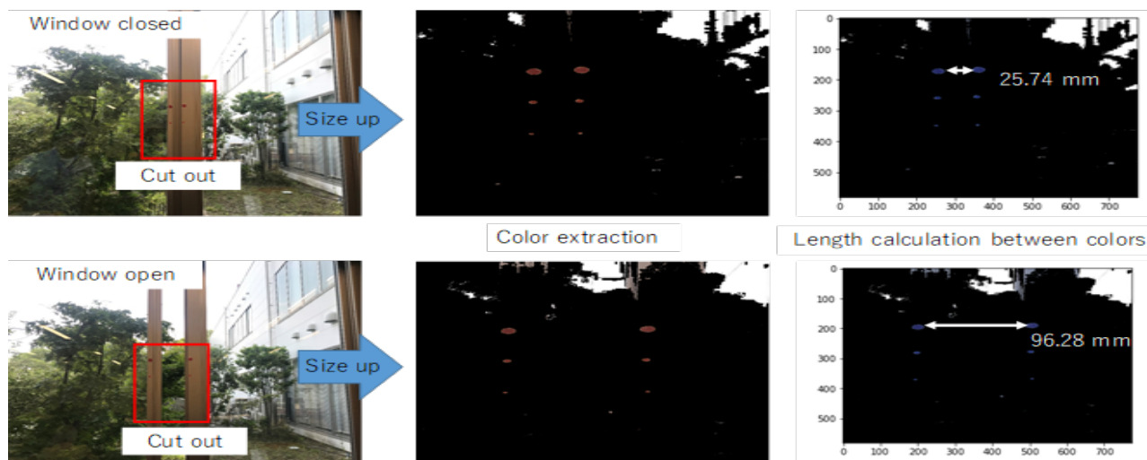
図5 画像処置を用いた窓の開閉判別
